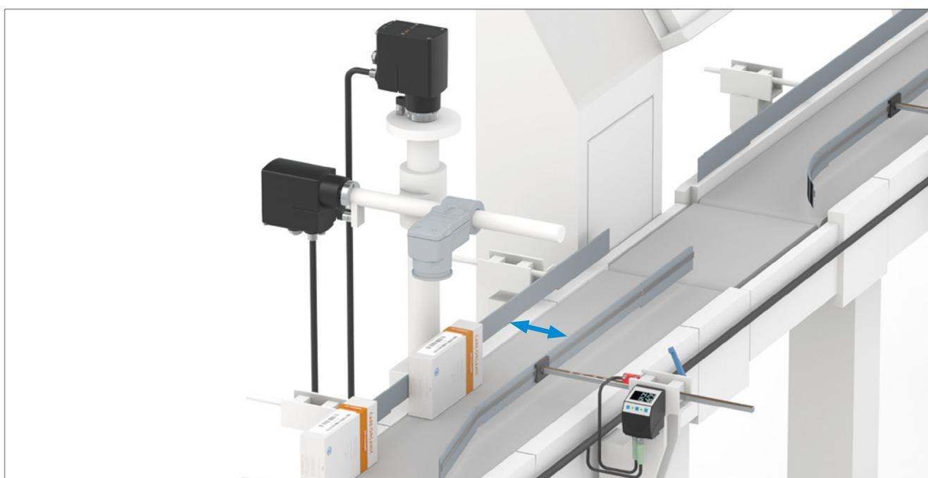
Riappontamento rapido e sicuro del magazzino per astucci e scatole pieghevoli. A seconda delle dimensioni dell'imballaggio e delle proprietà del materiale, i rispettivi assi di regolazione devono essere reimpostati in modo sicuro e rapido. Gli attuatori compatti si spostano nelle nuove posizioni dell'asse premendo semplicemente un tasto. La dimensione successiva dell'imballaggio viene attuata automaticamente e con una sicurezza di processo del 100%.
