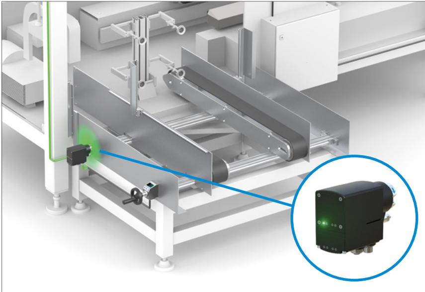
L'attuatore effettua la regolazione della larghezza della nuova unità di imballaggio praticamente solo premendo un tasto.
