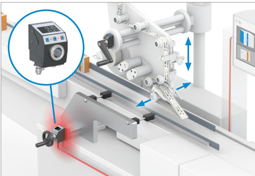
La guida del nastro trasportatore viene aggiustata in base al nuovo formato di imballaggio tramite il cambio di formato monitorato.
