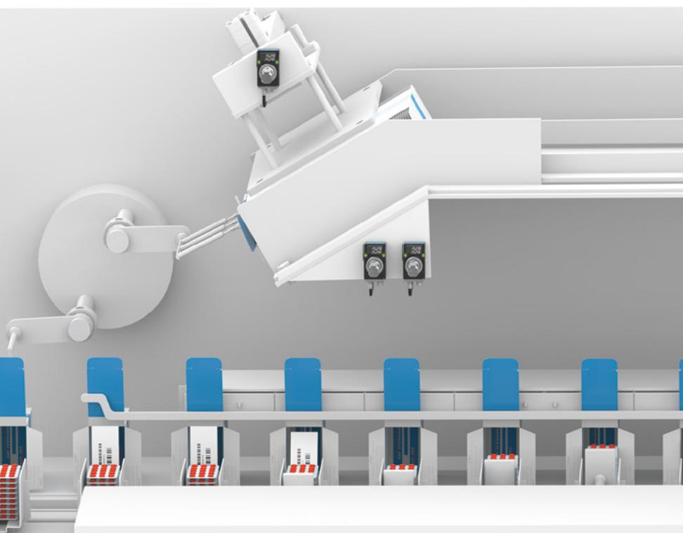
Gli indicatori di posizione compatibili con sistema bus monitorano la regolazione manuale e segnalano eventuali errori in modo visuale e tramite comunicazione bus. Un avvio di produzione con un'impostazione errata del formato è quindi escluso al 100%. I LED di stato e gli indicatori di direzione facilitano all'operatore un'impostazione rapida e precisa.
