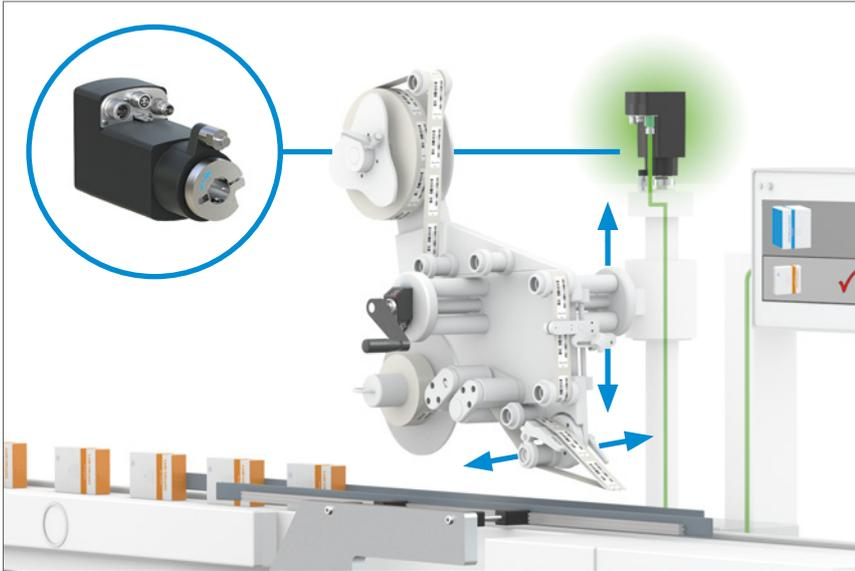
Gli attuatori assicurano una regolazione rapida e sicura dell'altezza del modulo di etichettatura in base alle dimensioni dell'imballaggio.
