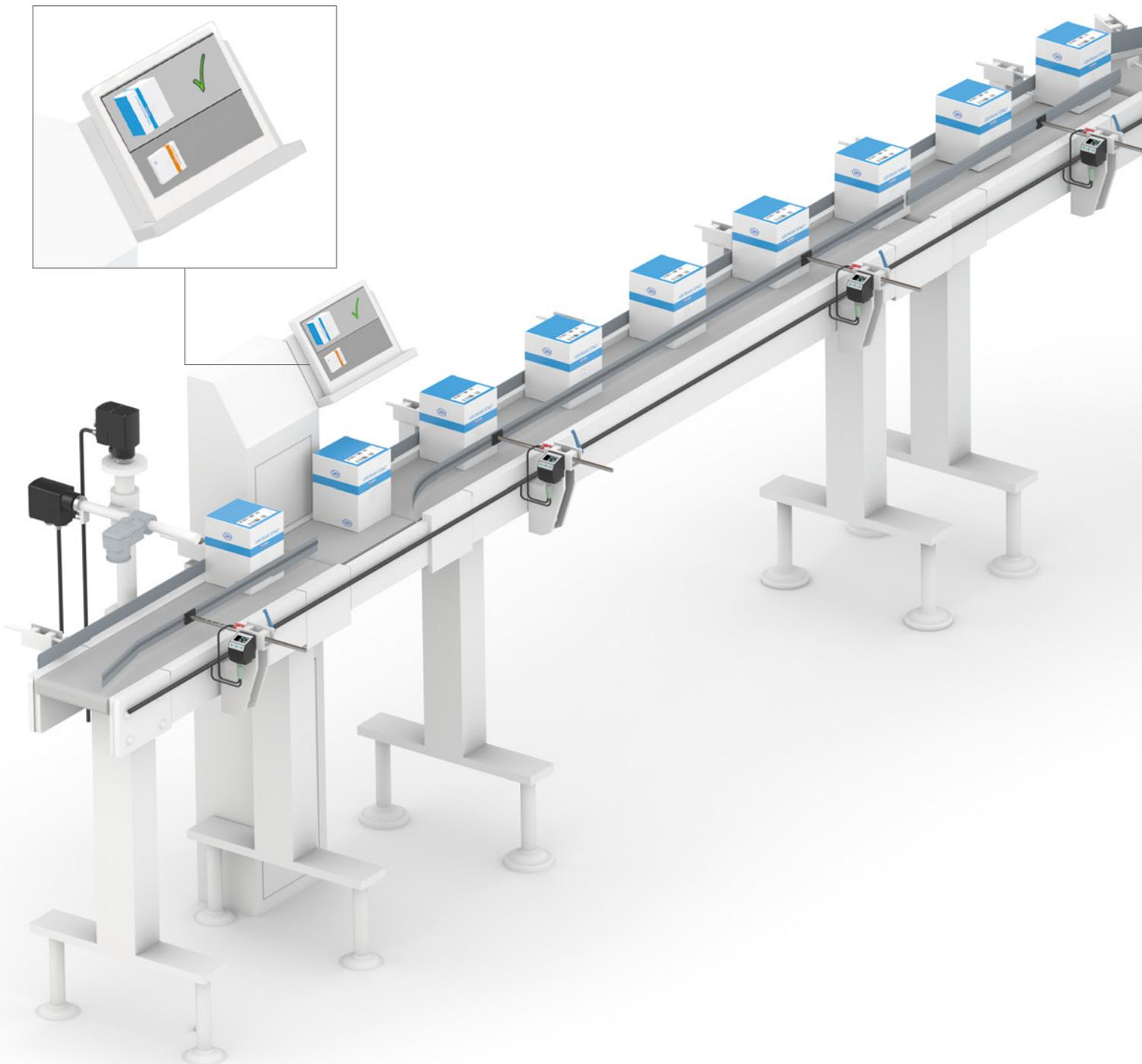
Gli attuatori sono utilizzati per regolare la telecamera orizzontalmente e verticalmente per rilevare la marcatura del prodotto.
