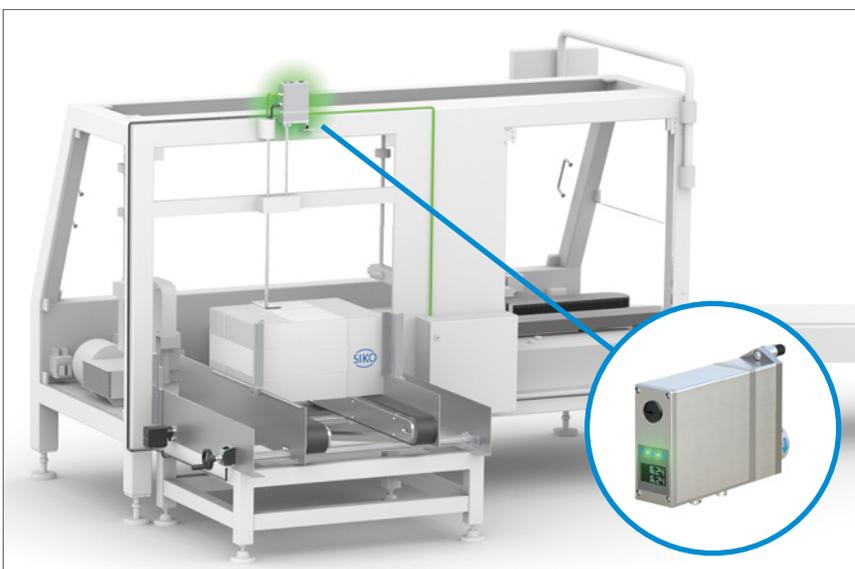
La regolazione dell'altezza del magazzino delle scatole di cartone avviene automaticamente tramite un attuatore. L'accesso complicato all'unità di regolazione consente la regolazione manuale solo con uno sforzo considerevole.
