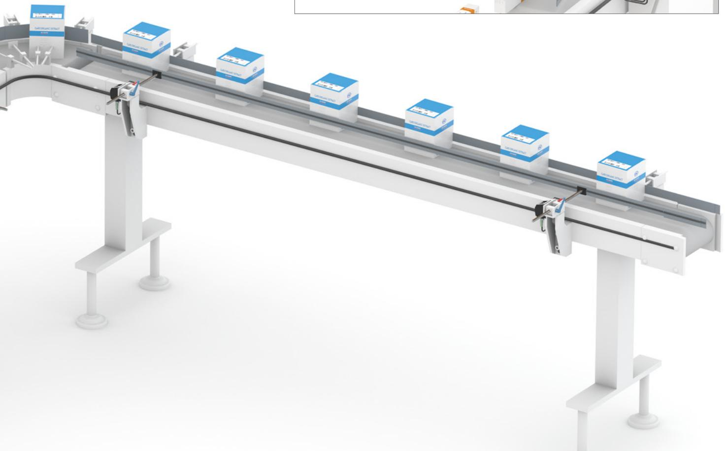
La regolazione lineare delle guide laterali dei nastri trasportatori è adattata ai rispettivi formati di imballaggio. Il monitoraggio tramite il controllore previene inceppamenti e scarti di materiale in caso di possibili operazioni di comando errate.
