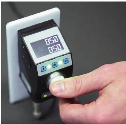
◀ Die elektronische Positionsanzeige AP20 eignet sich ganz besonders für die flexible Herstellung mit Produktionsmaschinen, wie zum Beispiel Verpackungsmaschinen und Holzbearbeitungsmaschinen. (Bilder: Siko GmbH)
