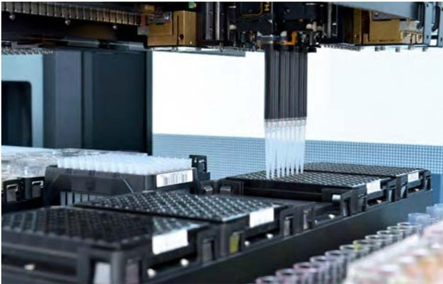
Die Positionierung der Pipettierspitzen muss äußerst exakt erfolgen.
