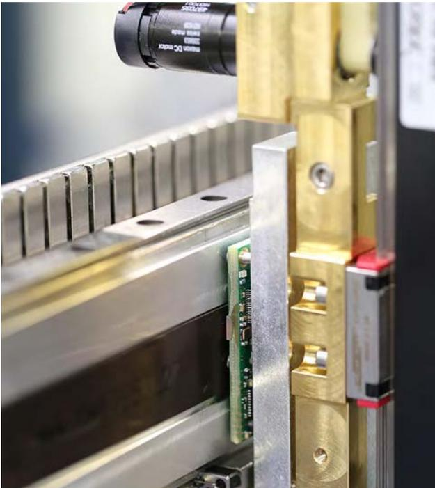
Eines der magnetischen Messsysteme, bei dem SIKO das Magnetband lieferte und der Encoder von Hamilton entwickelt wurde.
